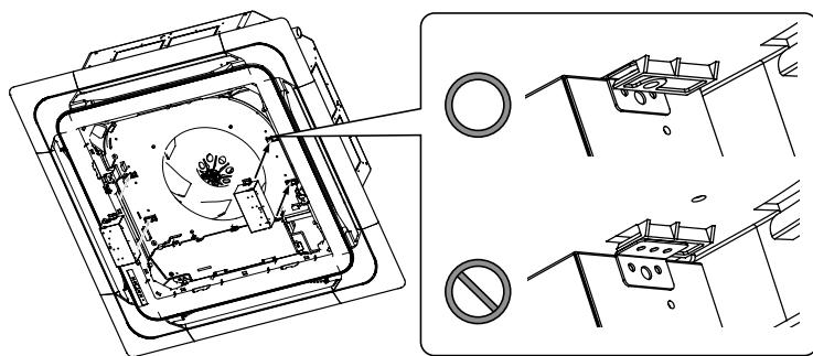
2. Откройте крышку блока выключателей и подключите разъем к этому блоку и к панели.
