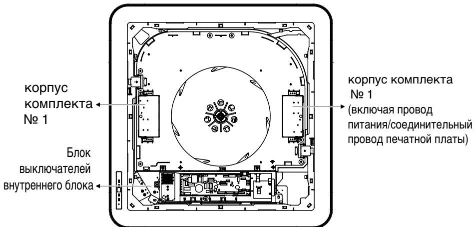
2. Правильно подключите провода подъемного комплекта, следуя инструкциям, которые приведены в руководстве по установке.
