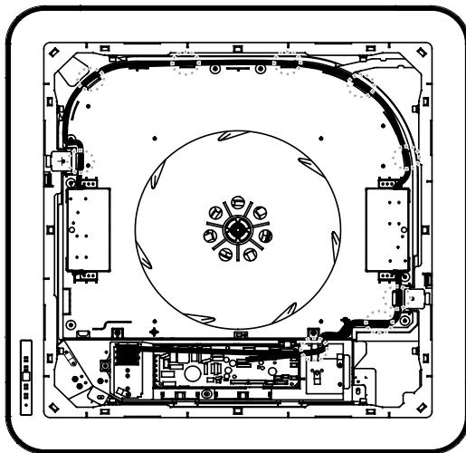
4. Подключите провод подъемного комплекта к решетке воздухозаборника на панели (те же 2 места).
