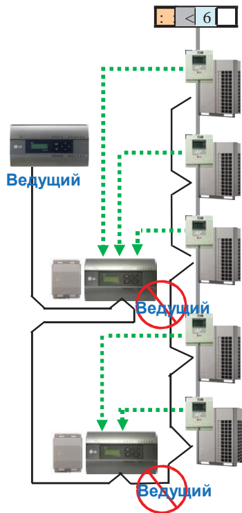
Неправильное подключение кабеля
