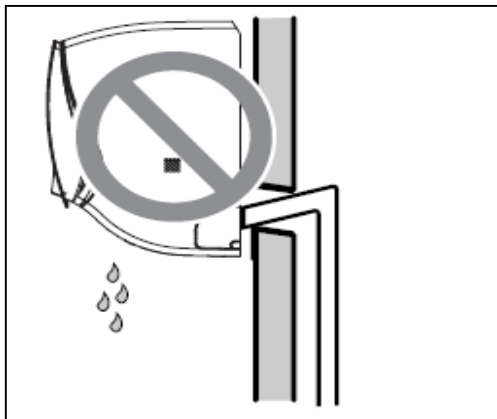
Случай 1 : Внутренний сливной шланг ниже, чем наружный.
