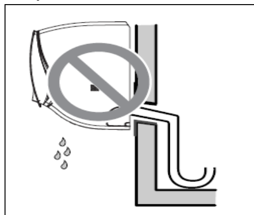
Случай 6 : Конец сливного шланга загнут вверх.
