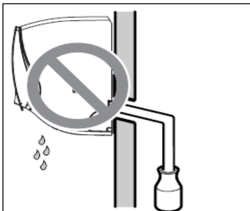
Случай 3 : Конец сливного шланга заткнули в бутылку.
