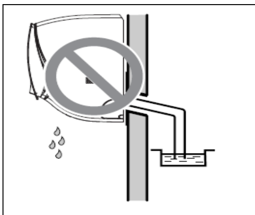
Случай 5 : Конец сливного шланга запирается в воду.
