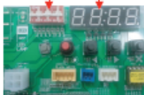
Плата наружного блока
