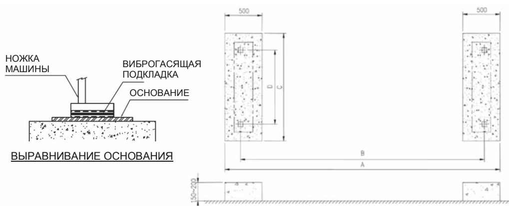
Рис. 7 Размеры фундамента (для стандартной модели)
