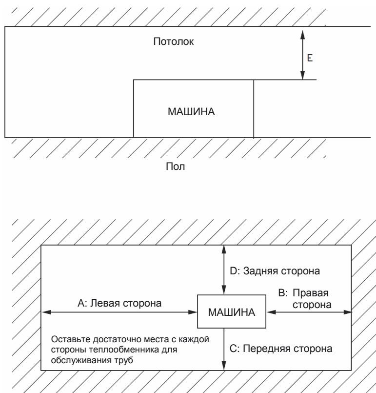
Рис. 4. Требования по минимальному свободному пространству при монтаже
